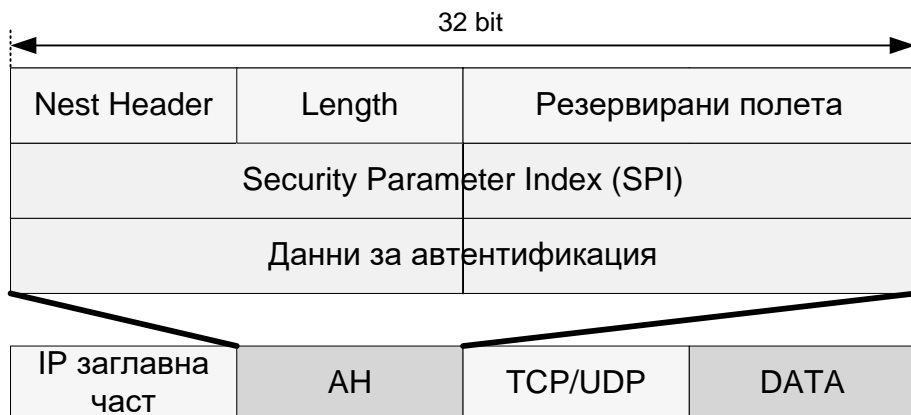
Фиг. 11.5 Структура на IP Sec дейтаграма
